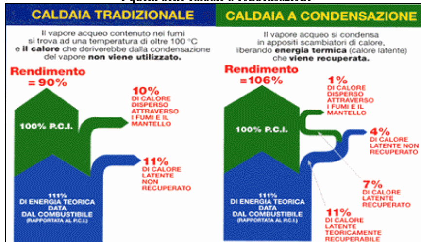
Fig.1 – Confronto tra i flussi energetici caratteristici delle caldaie tradizionali e quelli delle caldaie a condensazione
